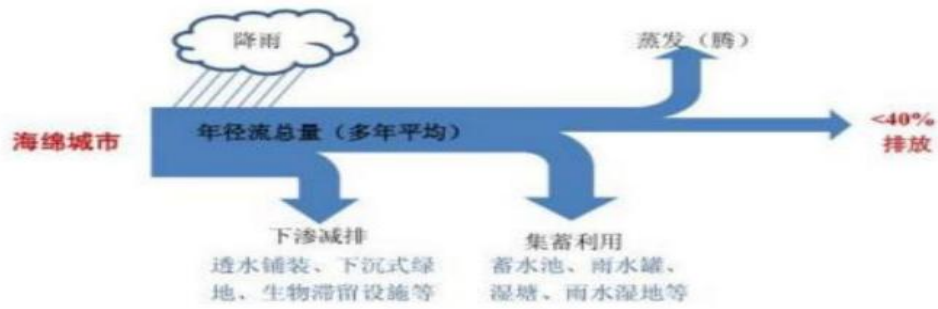
图 5-25 海绵城市径流空置率概念示意图
